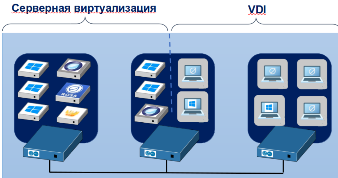
Рис.6. Совместное использование серверной и десктопной виртуализации
